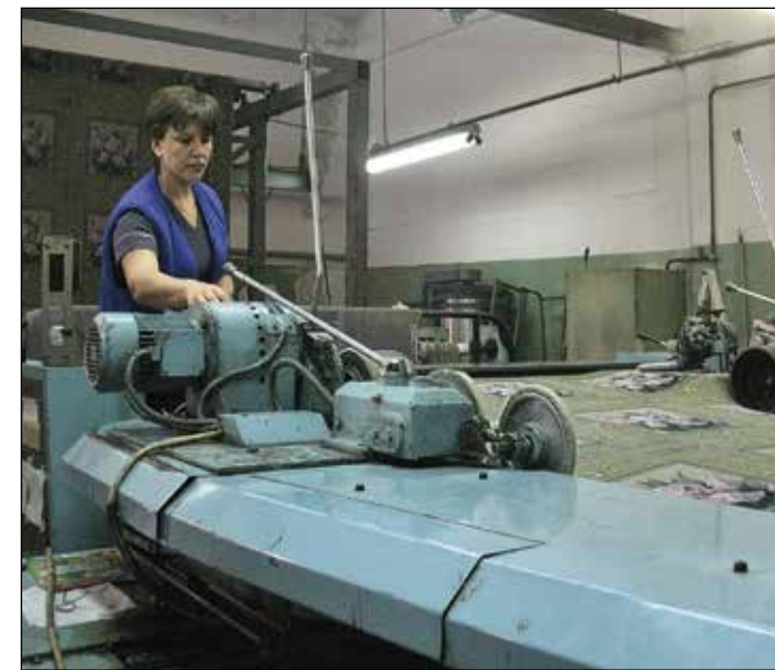
Только что сотканный рулон сушат и фиксируют по ширине
