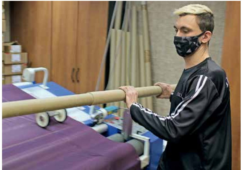
Основной рабочий инструмент Николая Кольдюкова — промерочная машина для отпуска готовых тканей (вверху)
