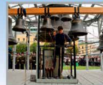
Система управления Исаакиевского собора позволяет одному человеку одновременно звонить на 14 колоколах
