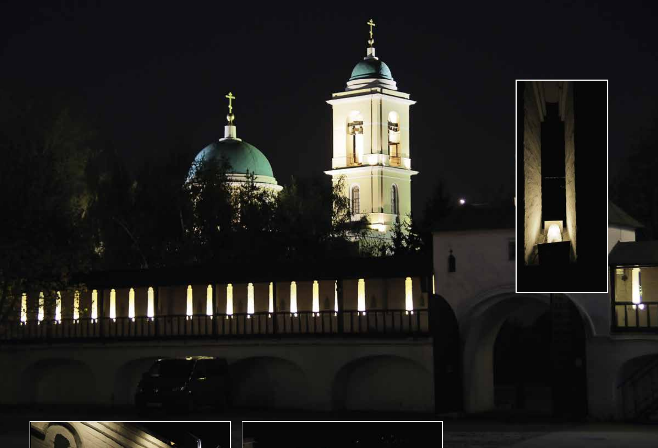
Ил. 12. Крепостная стена с установленными в прорезях зубцов компактными люминесцентными лампами — изюминка проекта архитектурного освещения московского Данилова мужского ставропигиального мужского монастыря
