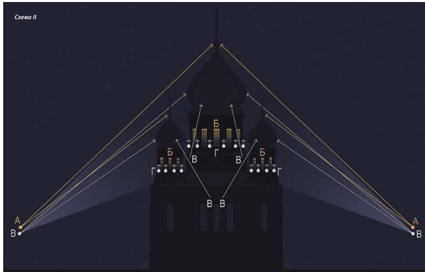
Ил. 5. Принципиальные проектные схемы архитектурного освещения храма с вынесенной колокольней (I) и четверика (II): А — Подсветка крестов глав с опор, ограды, стен окружающих строений или элементов самого здания; Б — Интенсивное высвечивание изнутри звонов на колокольне и внутренних пространств барабанов (второе — по возможности); В — Заливающая подсветка куполов, барабанов и стен здания с опор, ограды или элементов самого здания; Г — Локальная подсветка барабанов и простенков здания; Д — Подсветка фронтонов и различных декоративных элементов на здании (при необходимости и возможности); Е — Интенсивное высвечивание портиков и иных полуоткрытых пространств
