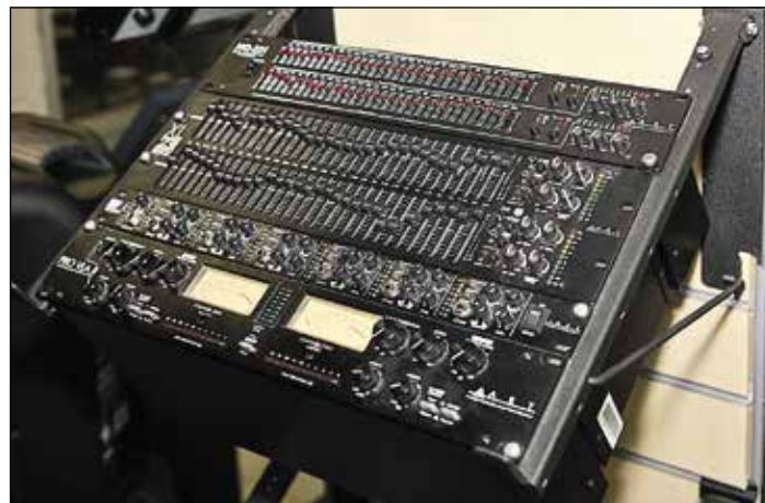
Микшерные пульта (вверху и внизу справа), эквалайзеры и подусилители (внизу слева)
