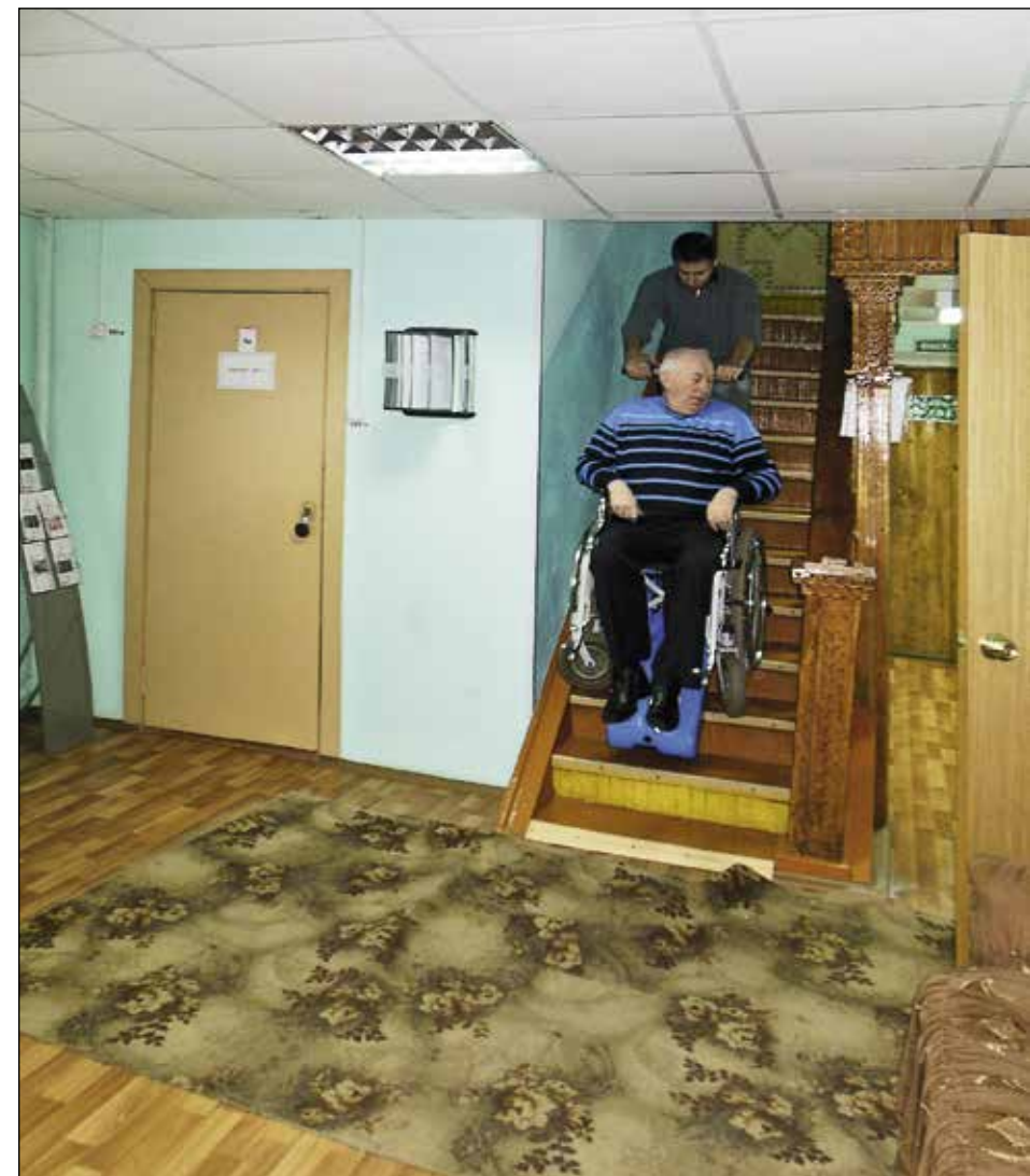
Мобильный гусеничный подъемник в работе
