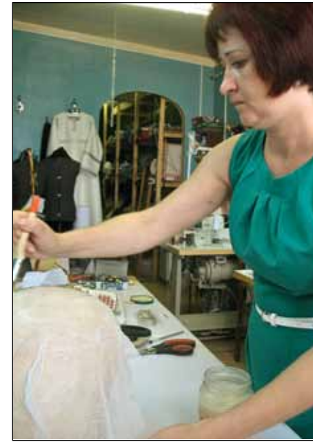
нижним слоем клейстера, формируем многослойный «пирог» из проклеенных слоев марли, проглаживаем получившуюся конструкцию утюгом
