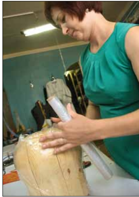
Последовательность операций при сборке заготовки (слева направо): оборачиваем болванку непроницаемым материалом, обмазываем ее
