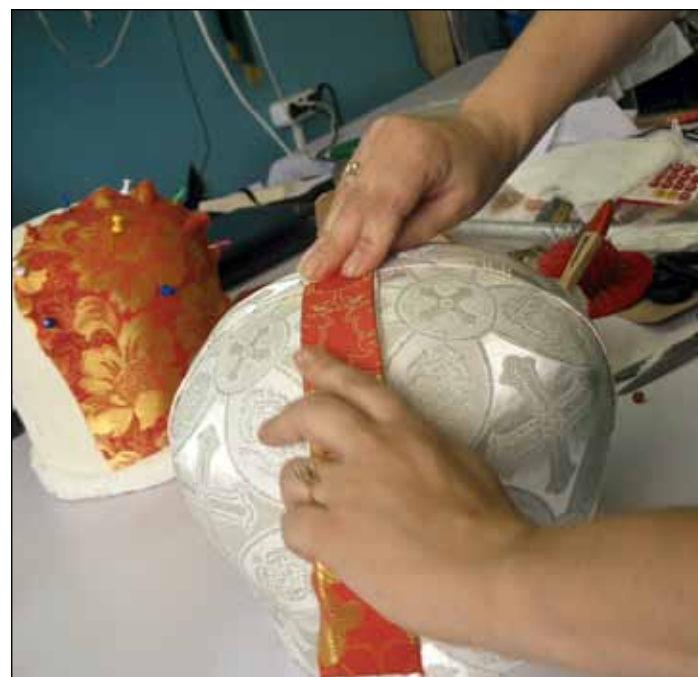
Прикрепление наружного слоя ткани к собранной заготовке
