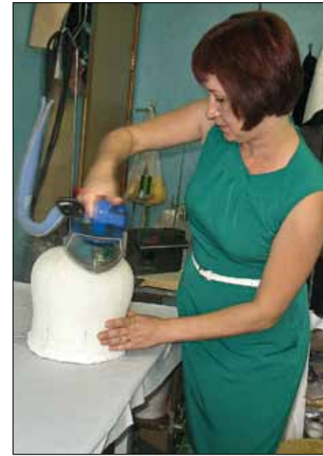
нижним слоем клейстера, формируем многослойный «пирог» из проклеенных слоев марли, проглаживаем получившуюся конструкцию утюгом
