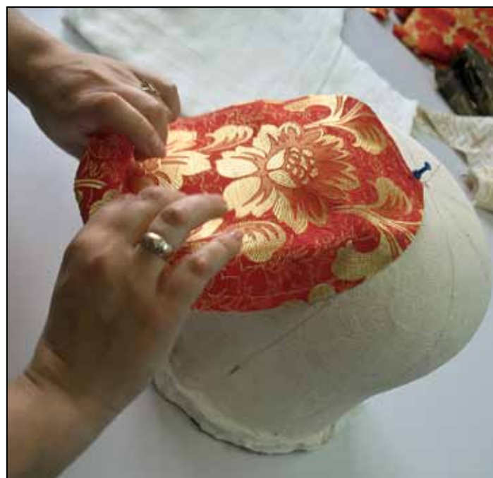
Прикрепление наружного слоя ткани к собранной заготовке
