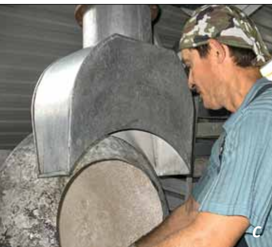
Алгоритм производства софринского ладана: очищенная сосновая живица раздробляется на гранулы (а), смешивается с синтетическим ароматизатором и обваливается толченым мелом (б) и путем взаимного механического трения друг о друга превращается в частички одинаковых формы и размера (с)
