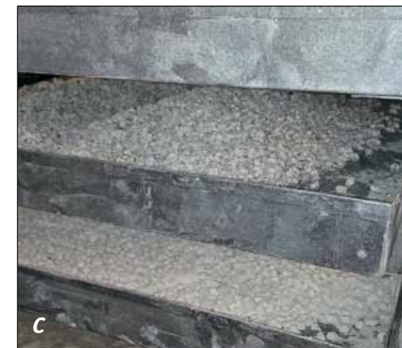
Классический алгоритм изготовления ладана: измельченная смола смешивается с ароматизатором (а), после отстаивания нарезается на мелкие «колбаски» (б), а в финале — на отдельные кусочки (с)
