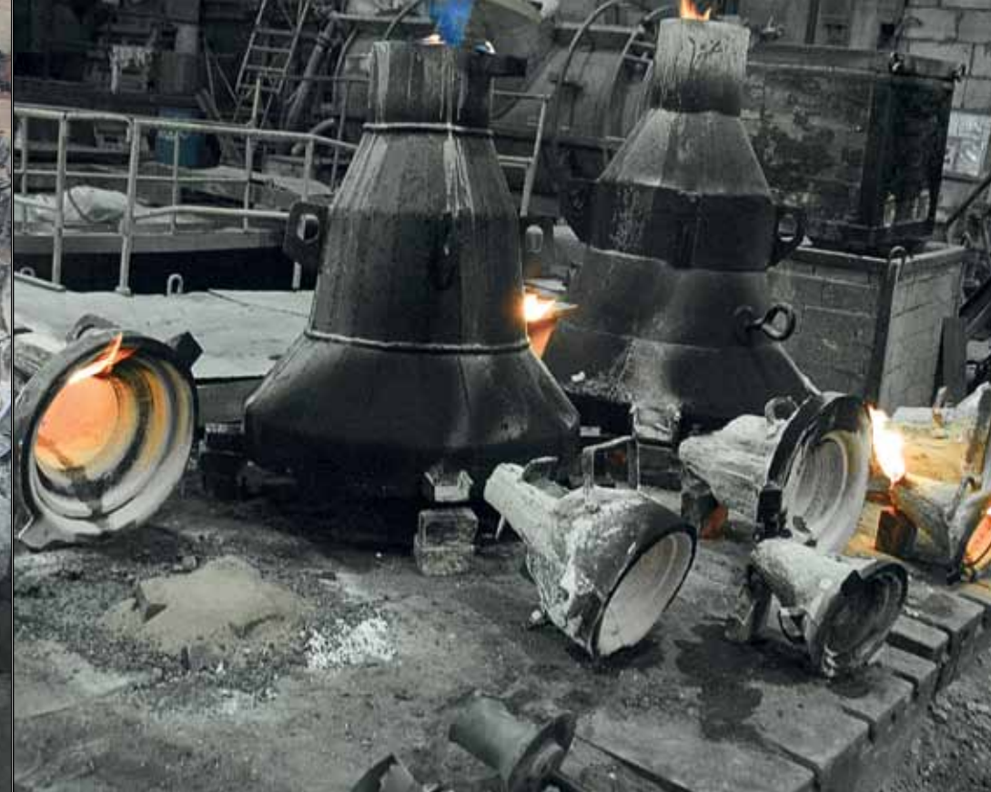
Отжиг готовых колоколов для удаления из них влаги и вредных газов
