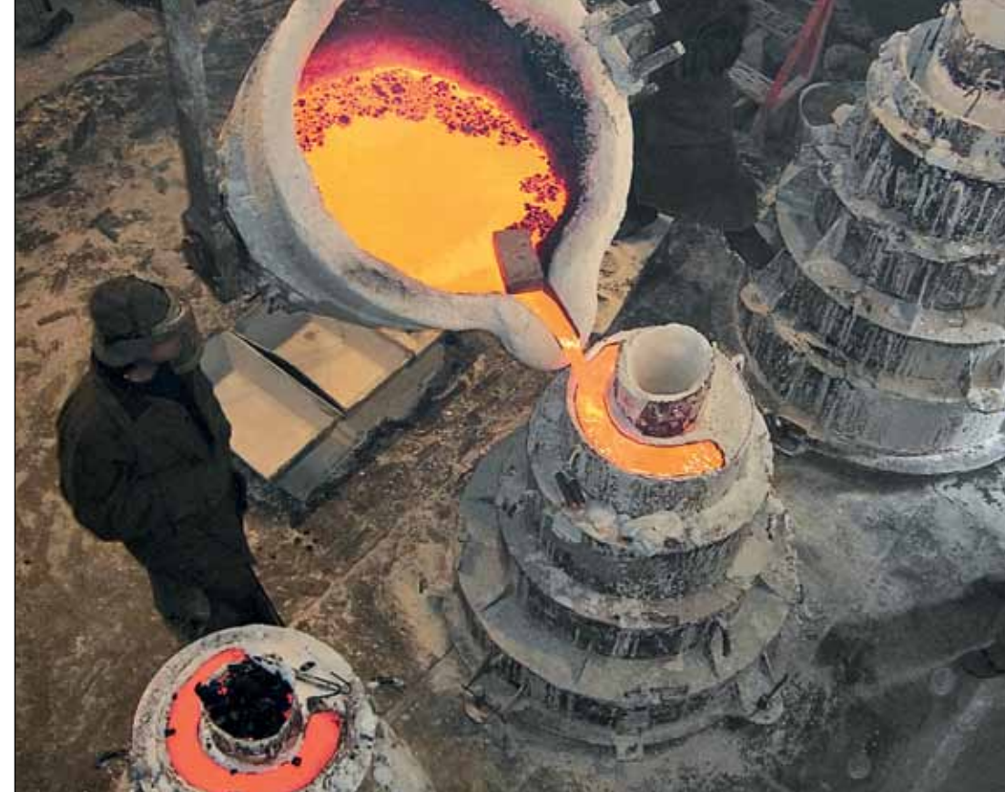
Отливка изделия промышленным методом
